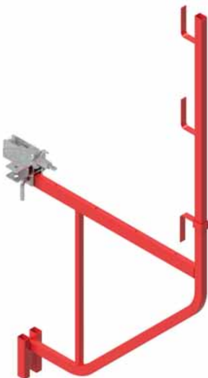
Консоль ходова STMAX Припустиме навантаження: 150 кг/м 2 , максимальна відстань - 1,35 м
